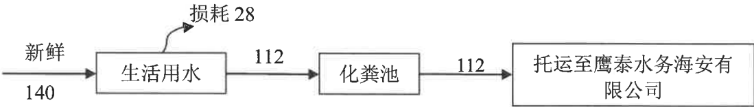
图 2-1 项目给排水平衡图 (t/a)
