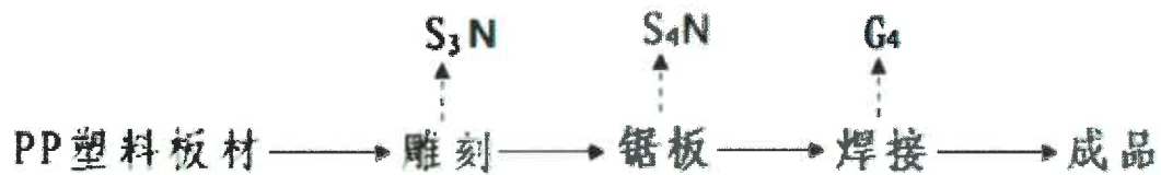
图 2-2 塑料结构设备生产工艺流程及产污节点图
