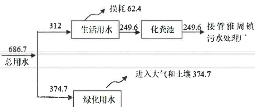
图 2-1 项目用排水平衡图 单位 t/a
