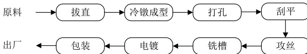
图 4.1-2 条帽生产工艺流程
