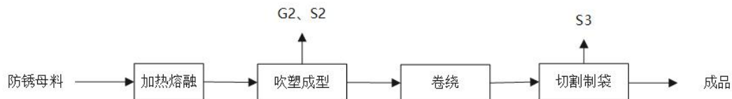
图 2-3 防锈膜生产工艺流程图
