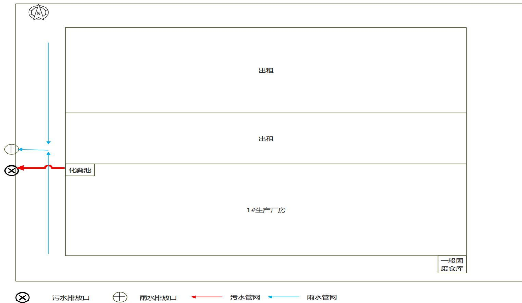
附图3 建设项目平面布置及雨污分流示意图
