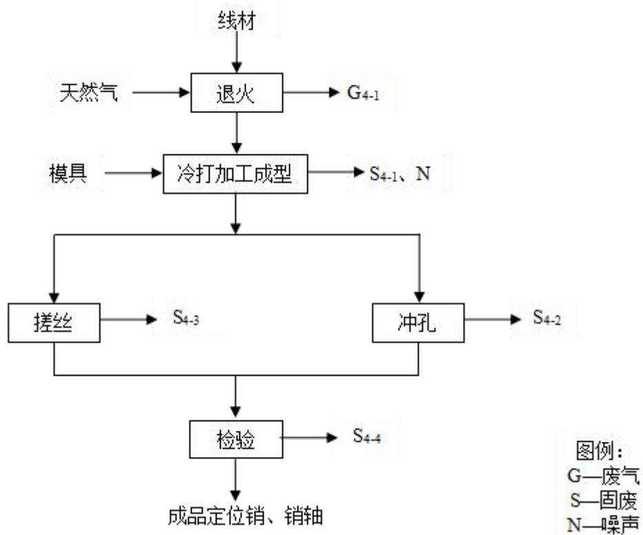
图4-4 线材前处理工艺流程图
