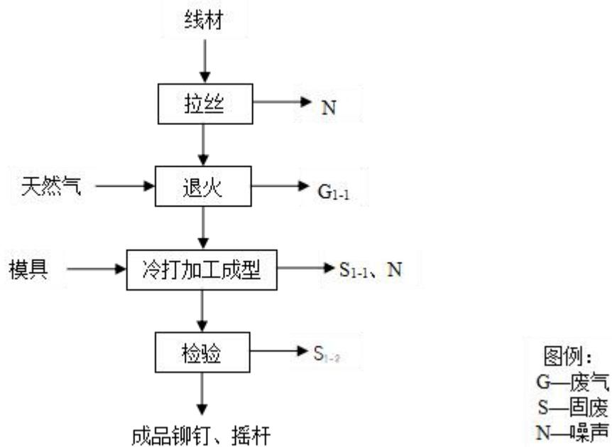
图 4-1 铆钉、摇杆生产工艺流程图
