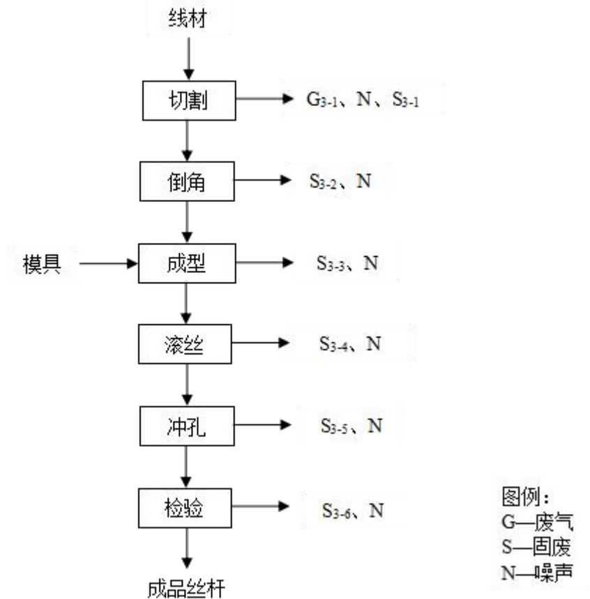
图4-3 线材前处理工艺流程图
