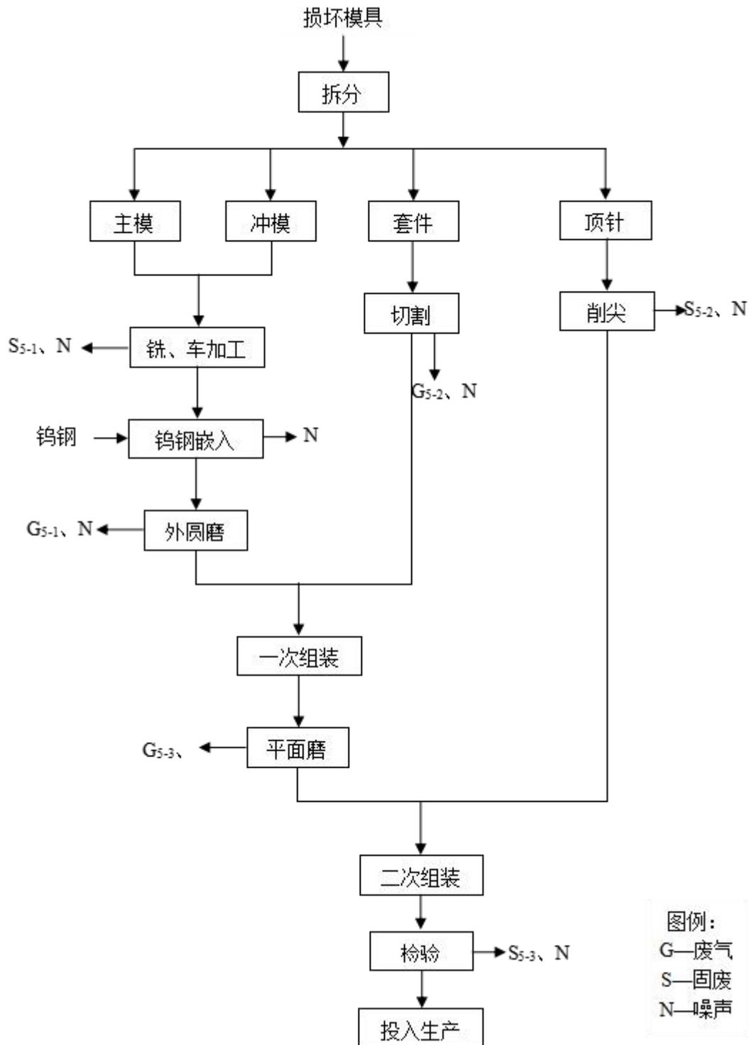
图4-5 模具加工工艺流程图
