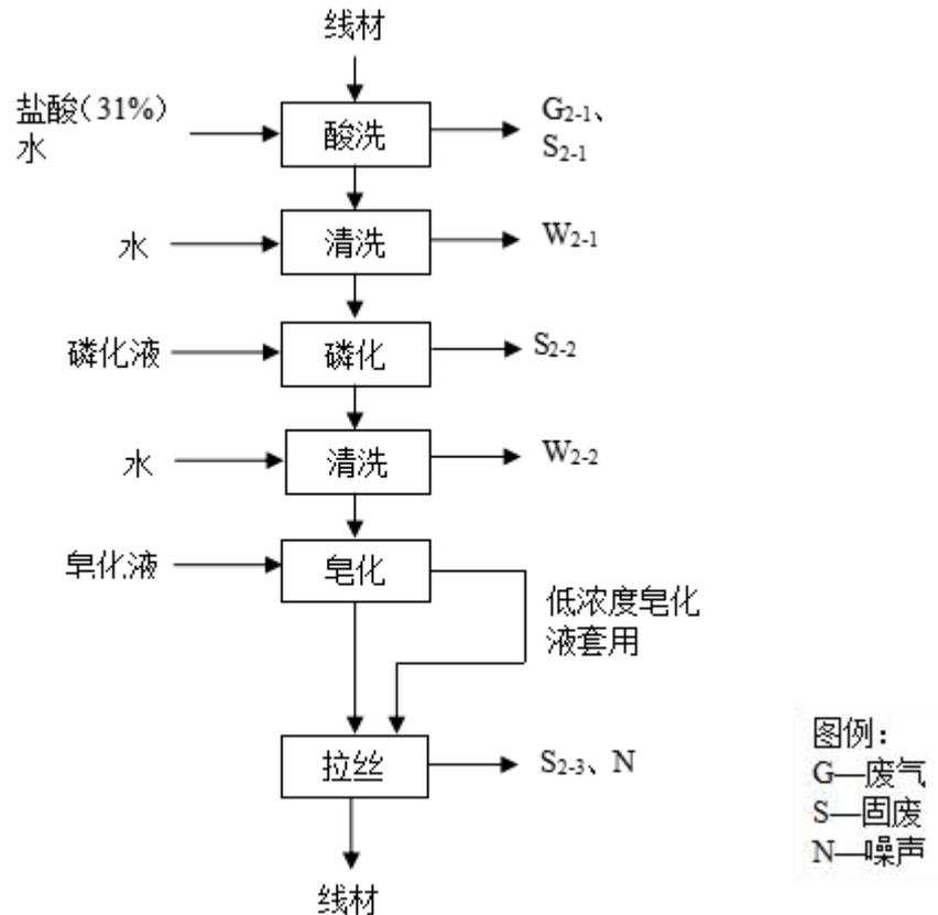
图 4-2 线材前处理工艺流程图
