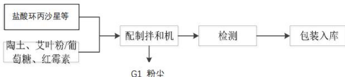
图 4-2 蚕用散剂、胶囊生产工艺流程及产污节点图
