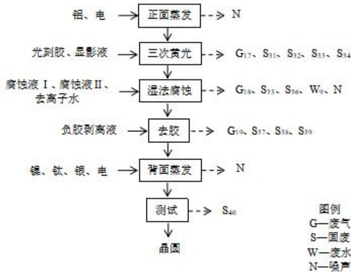
图 4-1 晶圆生产工艺流程图
