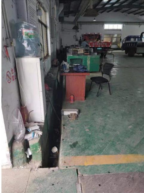
图 4-1 生产及仓储区域（四周有导流槽，且地面刷环氧底漆防腐防渗）
