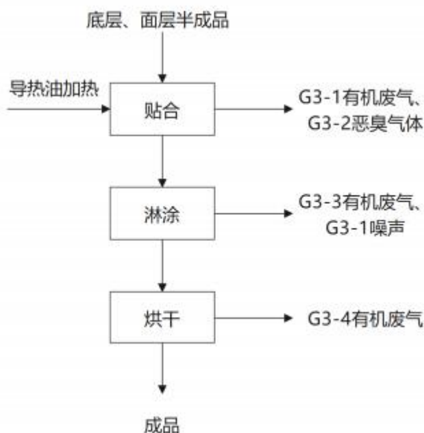
图 2-5 成品生产工艺流程图
