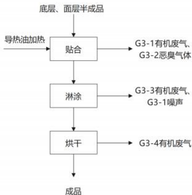
图 1.5.4-3 验收成品生产工艺流程图
